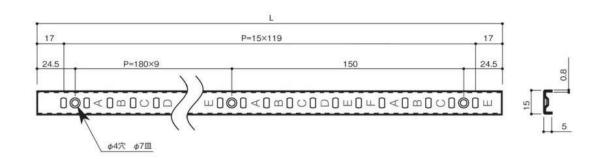
スタンダードの棚受で取り付け・取り外しが容易で抜けにくい構造。 ラバー付は棚板が滑りにくく、ガラス棚板などにも最適です。
