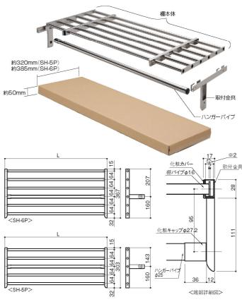
※2 ご指示いただいた壁幅に対して取付金具内で±10mm対応。 (例:オーダー寸法 500mm→実寸法:490~510まで対応)
